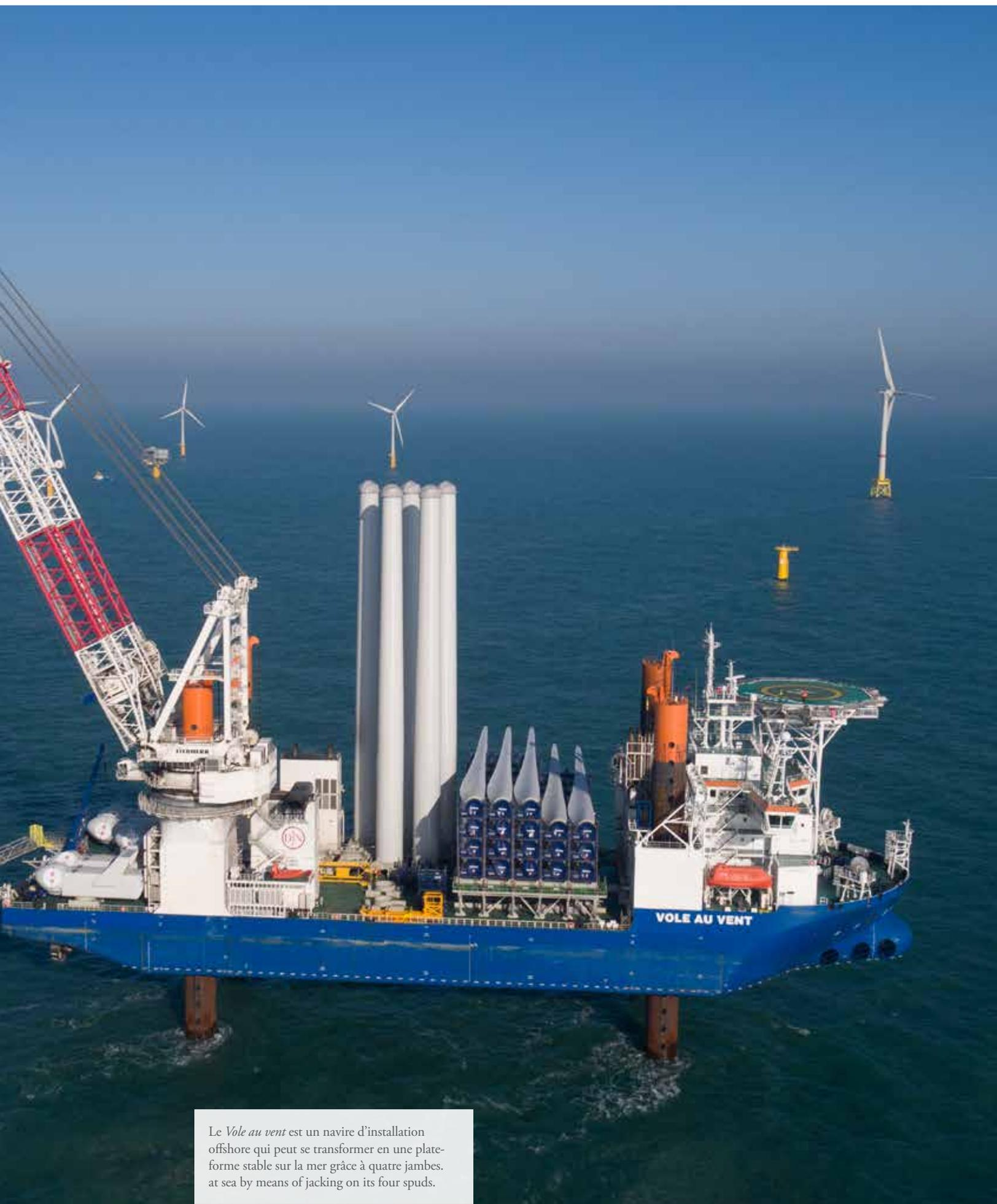
Le *Vole au vent* est un navire d'installation offshore qui peut se transformer en une plateforme stable sur la mer grâce à quatre jambes. at sea by means of jacking on its four spuds.
